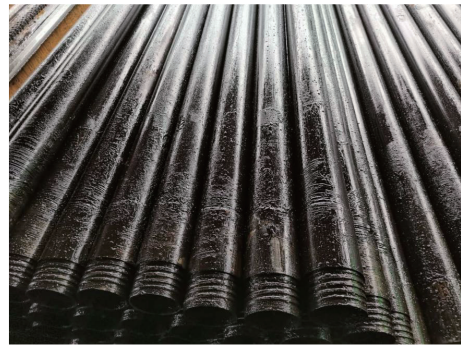
图7 钻进使用后附着在钻杆表面的润滑脂状态
