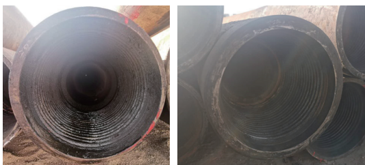
图3 钻杆接头偏磨
