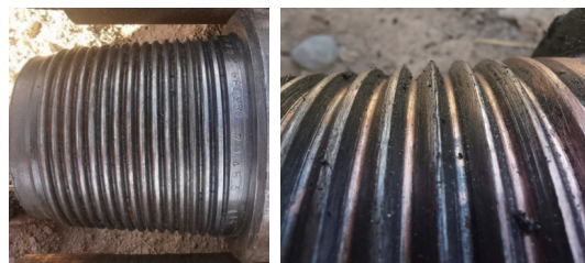
图4 螺纹牙顶磨损变尖
