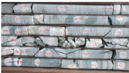
图4 新型绳索取心钻具所取得岩心
