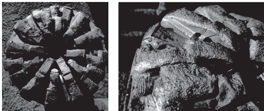
图3 Ø333 mm 表孕镶金刚石全面钻头出井后照片
