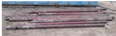
图5 射孔后的射孔枪
