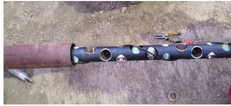
图4 组装完成的射孔弹
