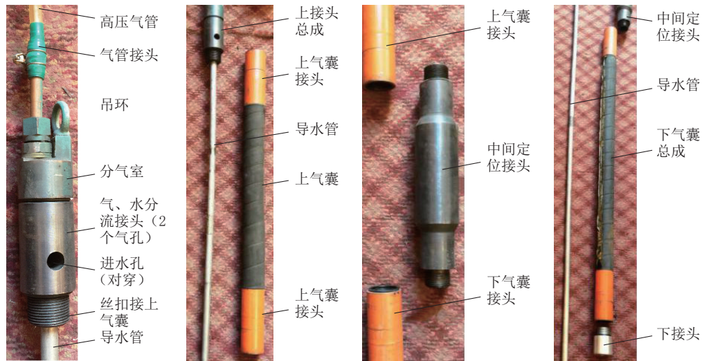
图 3 轻便式气囊隔离随钻压水试验器的实物结构
