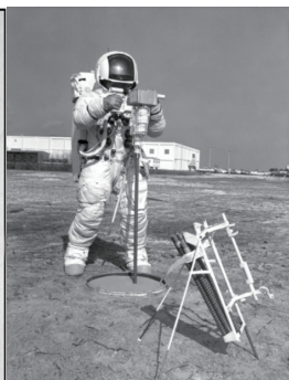
图11 Apollo15~17系列任务使用的钻进机具 [13,20,45]
