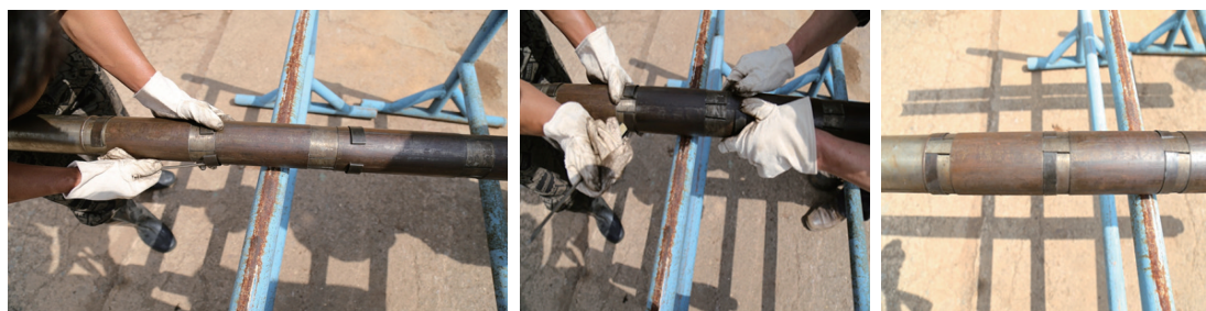
图5 半合管的安装及工作状态
