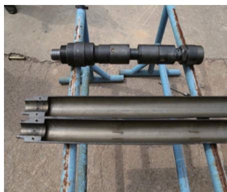
图3 取心器单动装置、单向阀及内壁光滑的半合管
