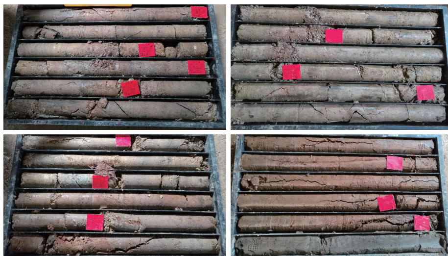
图7 半合管钻进工艺采取各含矿层位岩心照片
