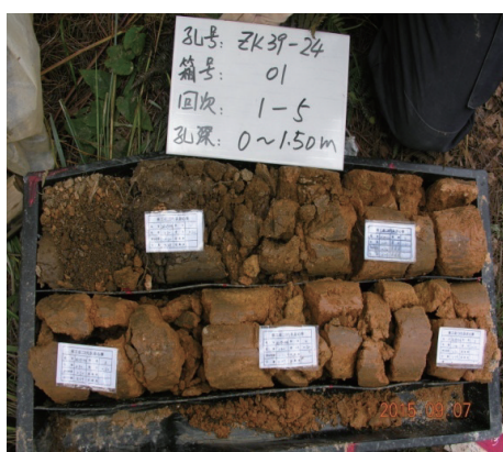
图2 从岩心管敲击取出的稀土矿岩心
