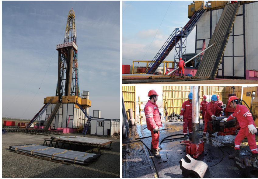
图2 铝合金钻杆在“松科二井”的工程应用
