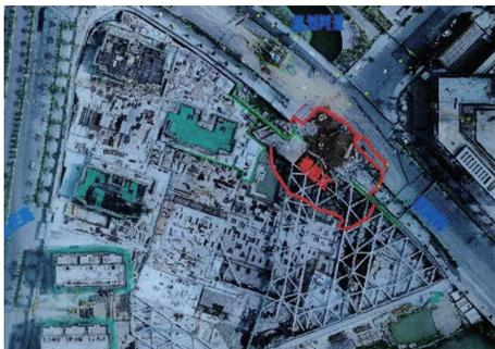
图5 基坑坍塌后的卫星照片
