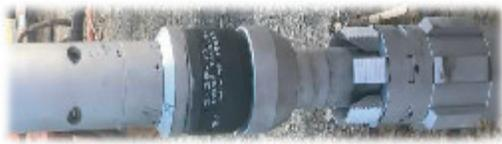
图 7 连续管密切割体积压裂新型封隔器
