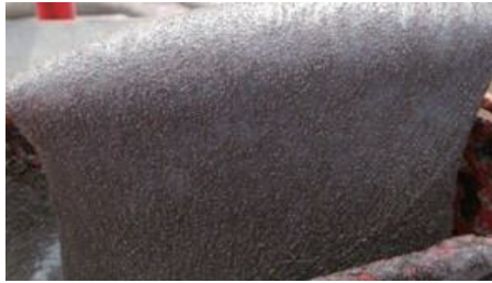
图 1 施工现场纤维压裂液
