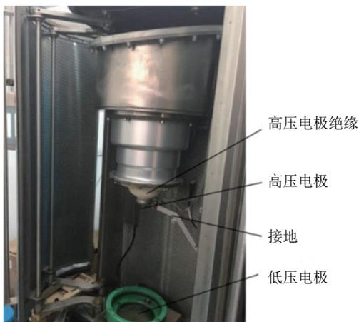
图2 高压工作电极部分
