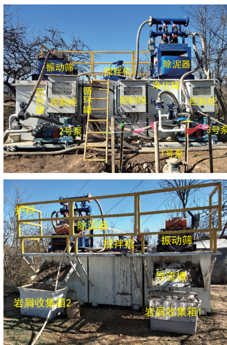
图2 砂岩型铀矿泥浆随钻处理装备结构
