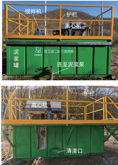
图3 硬岩型铀矿泥浆随钻处理装备结构
