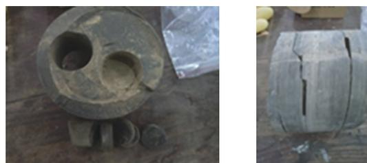
(a) 钻孔内取出的岩心 (直径95mm) (b) 岩心中钻取的试验小样 (直径30mm)
