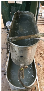
(a) 泥浆循环系统
