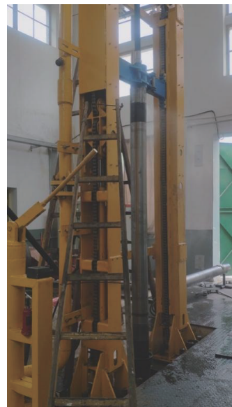
图5 YZX178型液动潜孔锤室内试验
