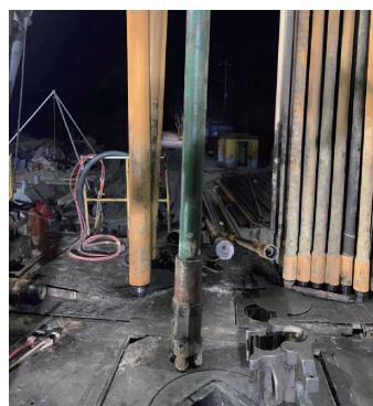
图 11 第二、三回次取心钻进牙轮取心钻头钻具组合
