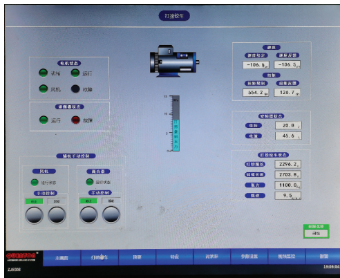
图 4 司钻房 HMI 显示界面
