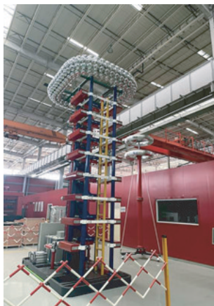
图14 高压放电破碎岩石实验装置
