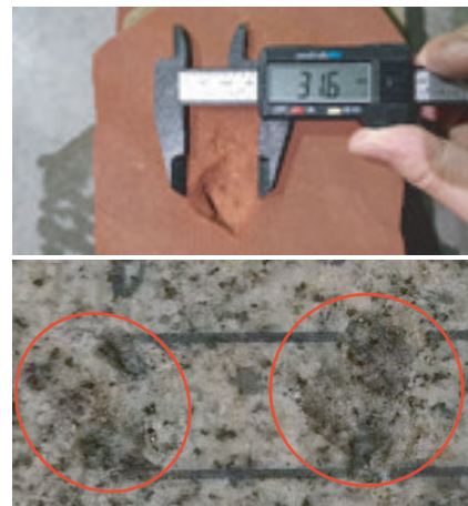
图15 高压放电破碎岩石实验结果
