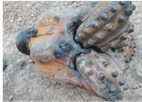
图7 钻头进水(渣)口防堵保护
