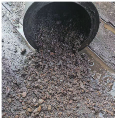
图6 起钻清理出钻具内的堵塞物
