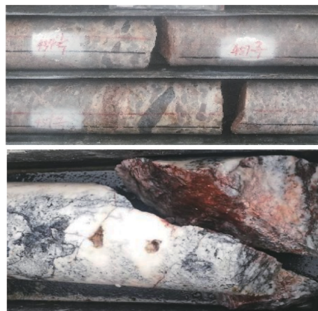
图2 钻穿溶洞后获取的岩心
