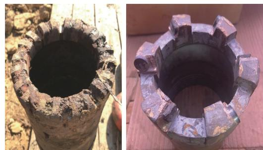
图 6 钻头泥包及 PDC 钻头崩齿现象
