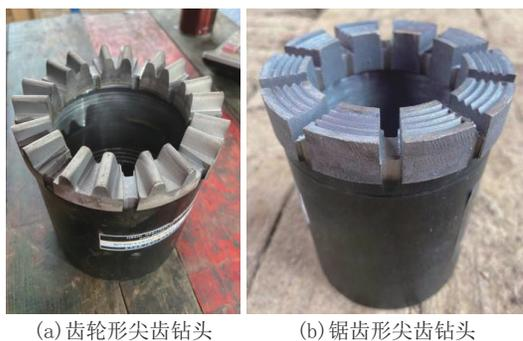
图7 优化后的金刚石钻头
