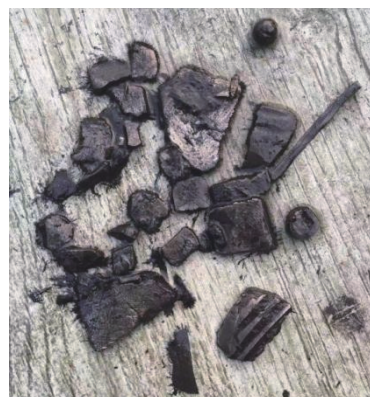
图 3 强磁打捞器捞起的部分铁块及铁屑
