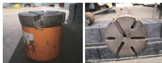
(a) 平底全面金刚石钻头
