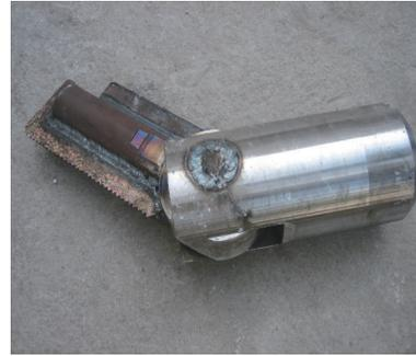
图1 喷射式扩孔掏穴器
