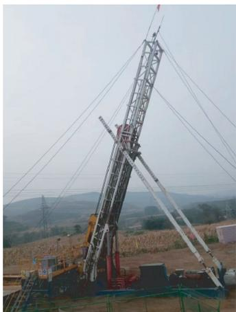
图4 MZJ-90Y型斜井全液压动力头钻机在SHH05-2(9)井施工现场
