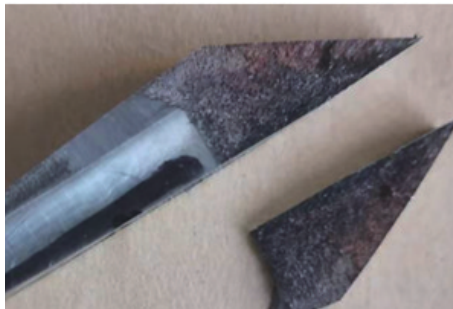
(a) 断口氧化和腐蚀形貌
