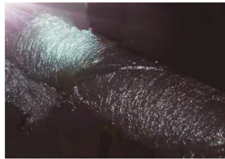
图3 煤矿井下孔口钻具钻渣附着情况
