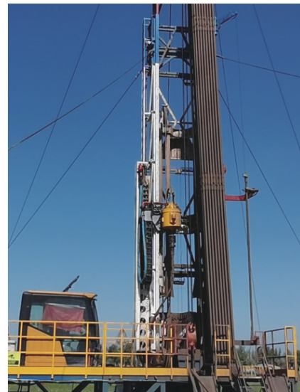
图8 钻杆处理装置作业
