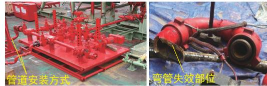
图2 管汇布置结构及失效照片
