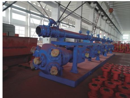
(b)改进后的压裂管汇结构
