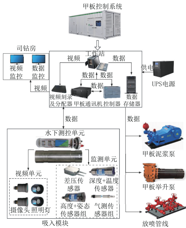
图 5 控制系统硬件架构
