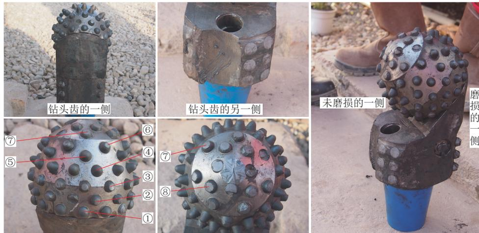
图 3 现场试验钻头切削齿和保径齿磨损
