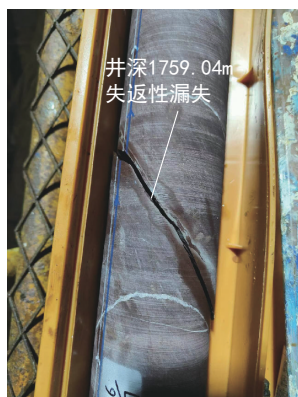
图6 井漏岩心图片
