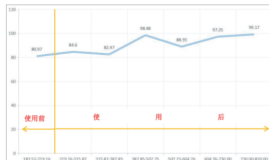
图4 X-A 成膜体系钻井液使用前后岩心采取率对比
