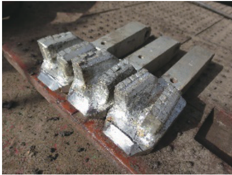
图 4 锻铣工具限位器打磨后实物 Fig.4 Image of forging and milling tool
