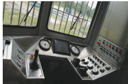
图3 改进的HXY-8VB钻机操作室
