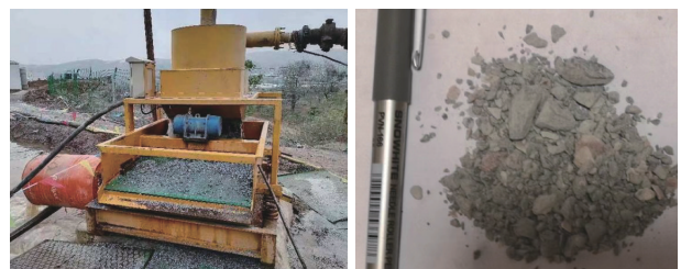
图5 气举钻进排出的岩屑
