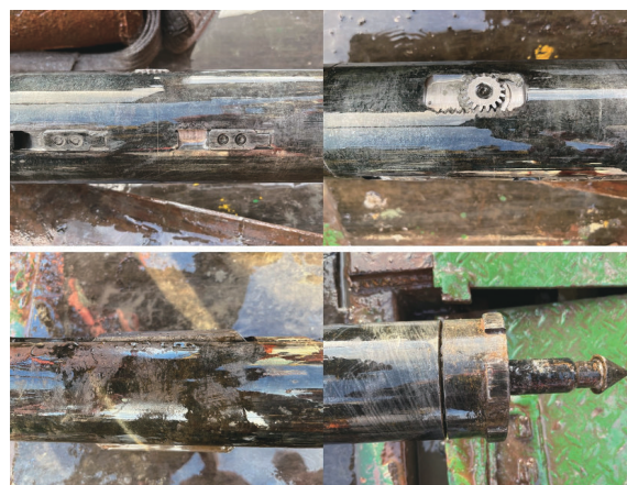
图9 弹卡机构执行正常,球阀翻转到位
