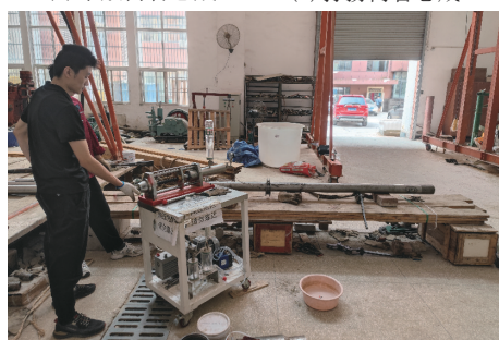
(d) 地面打压试验
