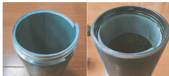
图10 铝合金钻杆与钢接头连接试样断口
