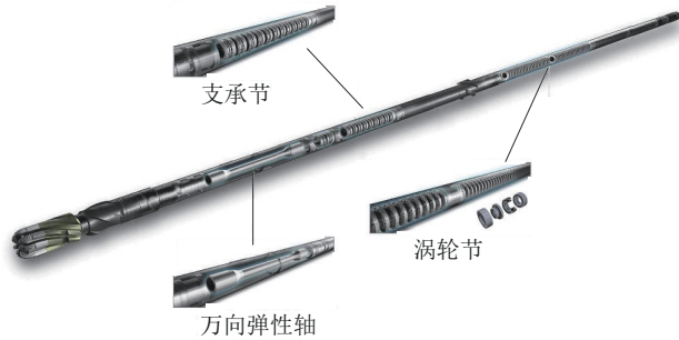
图3 涡轮钻具结构示意图
