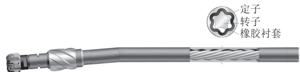
图2 螺杆钻具结构示意图
