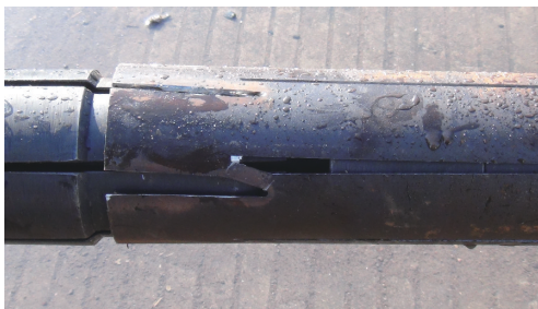
图7 膨胀管管端出现的问题
