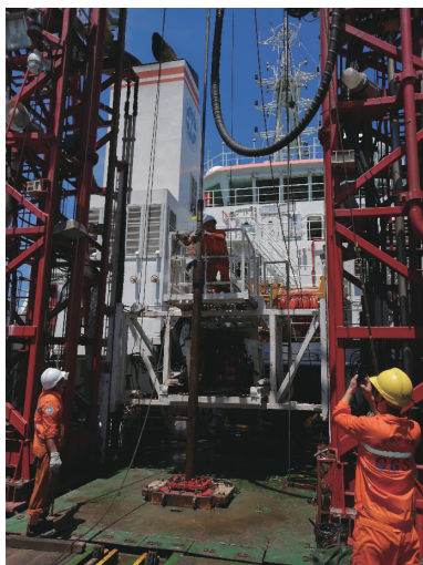
图4 组装活塞压入取心钻具
