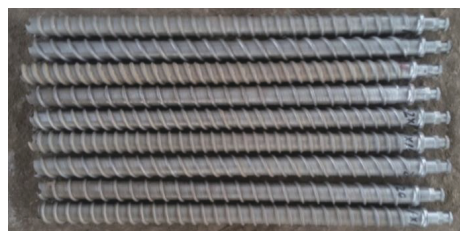
图9 不同规格试验用螺旋钻杆
