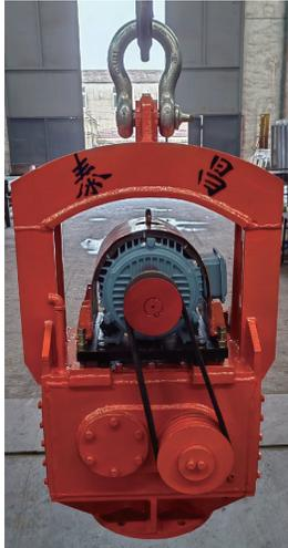
图1 振动拔管器实物
