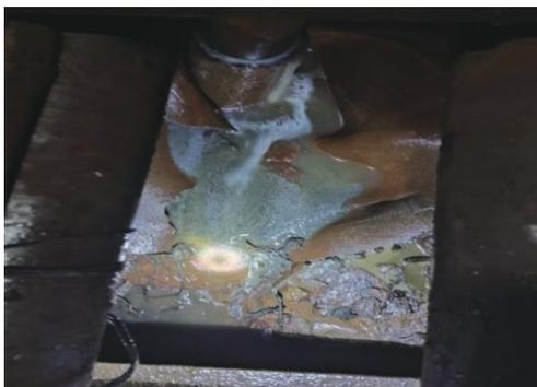
图2 锡铁山涌水钻孔
