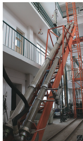
图7 水平井携岩试验架
