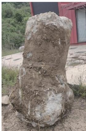
图13  $\text{O}800\text{ mm}$  扩底桩成桩效果
