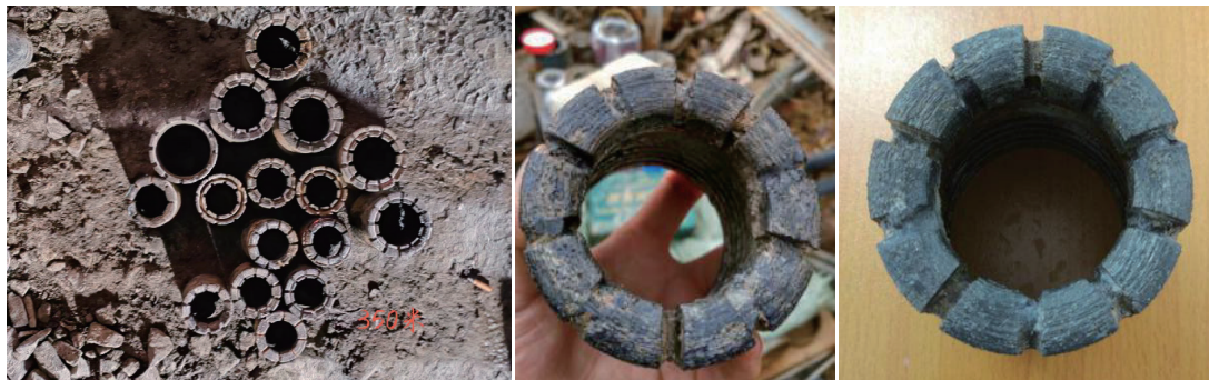
图4 钻头磨损实物
