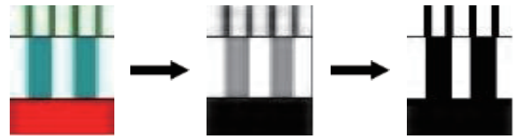
图7 第一界面灰度化、阈值化示例
