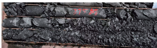
图5 现场深部煤层取心效果
