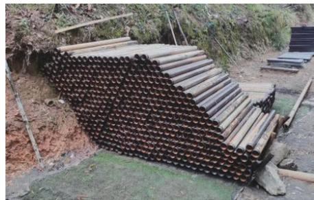
图9 1000 m 钻孔的钻杆
